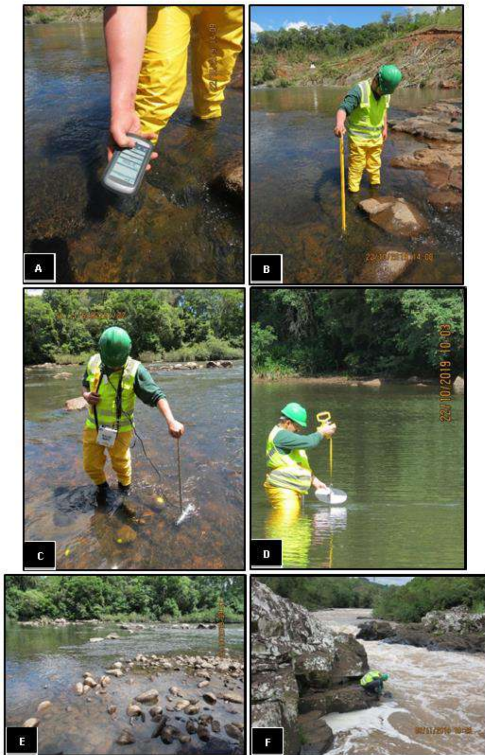
Figura 145 – Etapas do resgate de reófitas: A – Tomada de pontos GPS; B – Profundidade média; C – Transparência; D – Velocidade do fluxo hídrico; E – Substrato – Seixos e matacões; F – Substrato – lajeados.
